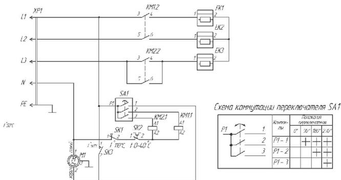
Рис.3 Схема электрическая ТВ 12/22СТ и ТВ 15/22СТ
