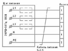
Рис. 6 Схема подключения розетки к стационарной сети
