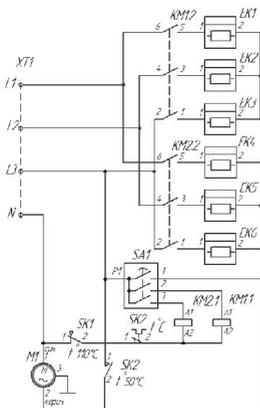
Схема коммутации переключателя SA1
