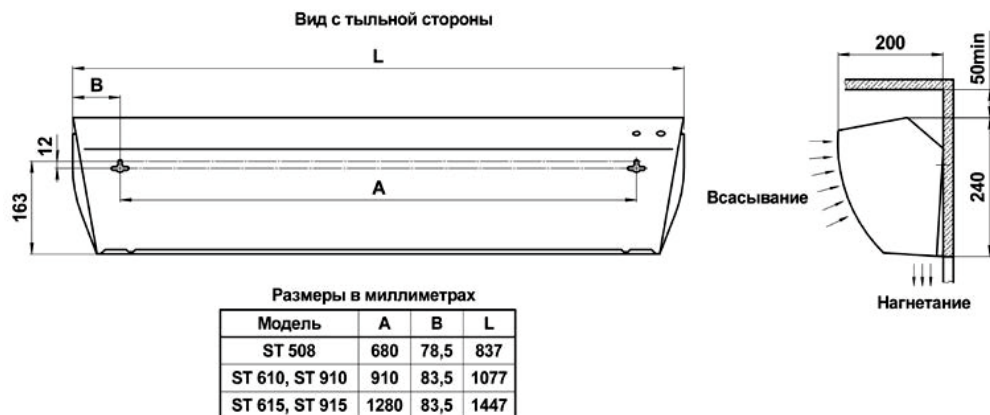
Рис. 2 Габаритные и установочные размеры
