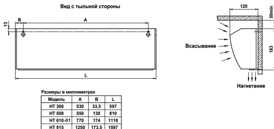
Рис. 3 Габаритные и установочные размеры
